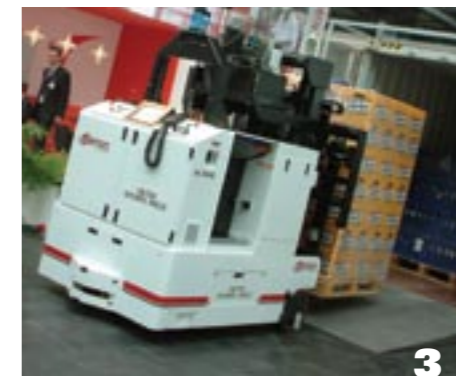
1. Ce monstre de Demag était sans conteste le plus gros véhicule à guidage automatique du salon. 2. L'appareil ADAM de RMT Robotics est peut-être petit mais il a tout ce qu'on peut attendre d'un VGA. 3. Le chargeur automatique de remorque d'Egemin
